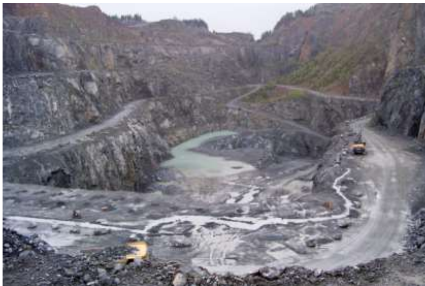
Abbildung 4: Ansammlung der dem bestehenden Tagebau hauptsächlich aus dem Übergangsbereich Locker- zu Festgestein zufließenden Wässer (Aufnahme bei Starkregen; Blickrichtung in Richtung Südwesten)
