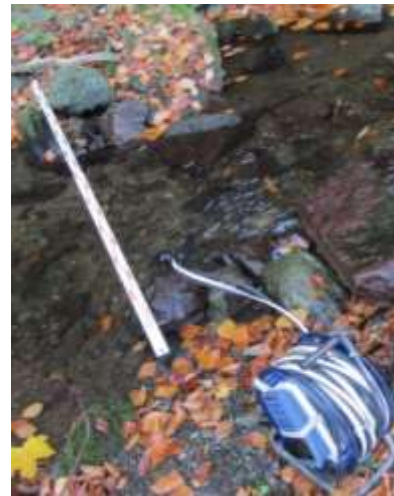
Abbildung 7: Messung der elektrischen Leitfähigkeit, des pH-Wertes, des Redoxpotentials, der Temperatur und des gelösten Sauerstoffs mittels einer Multiparametersonde
