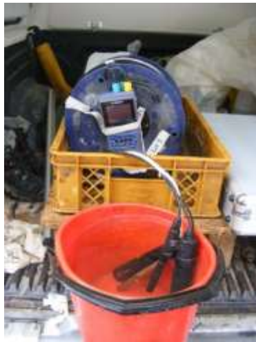
Abbildung 7: Messung der elektrischen Leitfähigkeit, des pH-Wertes, des Redoxpotentials, der Temperatur und des gelösten Sauerstoffs mittels einer Multiparametersonde
