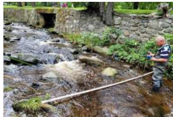
Abbildung 6: Links: Darstellung eines Messquerschnittes, rechts: Abflussmessung mittels elektromagnetisches Fließgeschwindigkeit Messsystem (August 2023)
