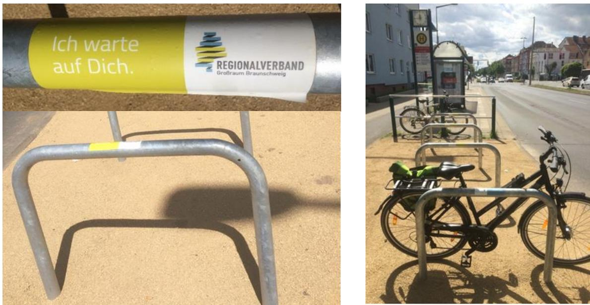
Abb. E 2-2: Anlehnbügel aus dem 1.000-Bügel-Programm (Bushaltestelle Gliesmaroder Straße, Braunschweig)
