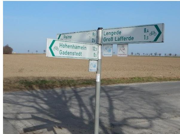
Abb. E 1-44: Zielwegweiser mit eingehängten Routenlogos für touristische Routen (FGSV-Standard)
