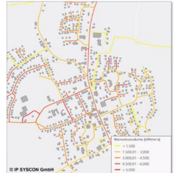
Gruppierung nach Wärmelinien-dichte (kWh/m Trassenlänge * a)
