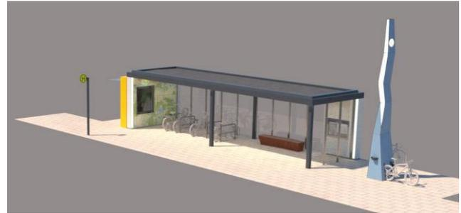
Die Funktionen der RegioBus-Haltestelle für Wendhausen beinhalten witterungsgeschützte Warte- und Sitzmöglichkeiten, überdachte Fahrradabstellplätze, einen Info-Monitor mit dynamischer Abfahrtsanzeige, eine Paketstation sowie eine Stele als „Landmark“ mit integrierter Fahrrad-Service-Funktion
