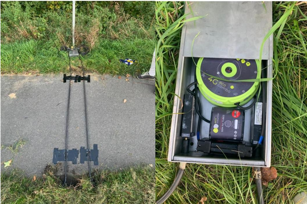
Abbildung 1-1: Zählanlage Eco Counter Tubes
